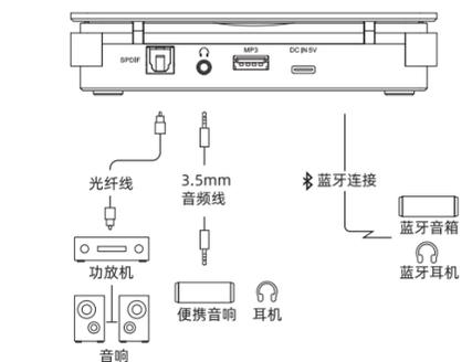
\*请选择其中一种方式连接，如若同时插入光纤线和音频线，可能导致音质受损
